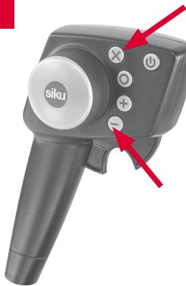
Současně stiskněte tlačítka **X** a **—** na ručním ovladači a držte je stisknuté. Potom ruční ovladač zapněte. Tlačítka **X** a **—** pustěte teprve tehdy, když bylo vytvořeno spojení mezi ručním ovladačem a traktorem.
