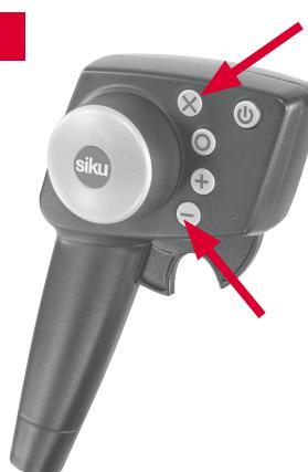
Die Tasten **X** und **-** gleichzeitig am Handsender drücken und gedrückt halten. Dann den Handsender einschalten. Die Tasten **X** und **-** erst loslassen, wenn die Verbindung zwischen Traktor und Handsender hergestellt wurde.
