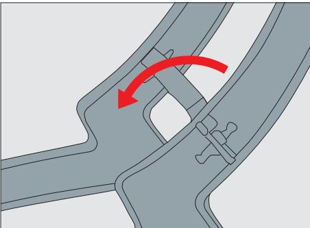
Um den Drehständer aufzubauen, steckt ihr die Enden des kleinen Bogens in die dafür vorgesehenen Schlitze der beiden großen bogenförmigen Füße. Dreht den kleinen Bogen in die richtige Position fest.
